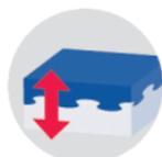
La Coextrusion est une solution 100% Innovante basée sur le principe de **fusion** de 2 matériaux, **le PVC et le PMMA**.
