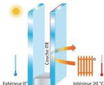
En hiver, ce système permet d'isoler du froid extérieur tout en laissant passer la lumière et la chaleur du soleil. Le vitrage conserve la chaleur à l'intérieur grâce à une couche dite ITR.
