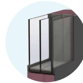
Pour une sécurité optimale, nos vitrages sont assemblés en triple vitrage feuilleté 33.2 retardataire d'effraction. Sans précision de votre part, vos portes PASSAGE vitrées sont munies de :
