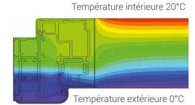
**Thermique :** calcul réalisé selon la norme EN ISO 10077-1 et -2 sur porte pleine avec dimension d'ouvrant de 2350 x 1070 mm et rejet d'eau. **AEV :** essais réalisés selon la norme NF P 20-501. N°404/2019/243-1 du 06/12/2019. **Ensoleillement :** selon norme NF EN 12219. **Acoustique :** Classification selon la norme ISO 717-1 sur porte pleine de dimension HT 2180 x 960 mm.
