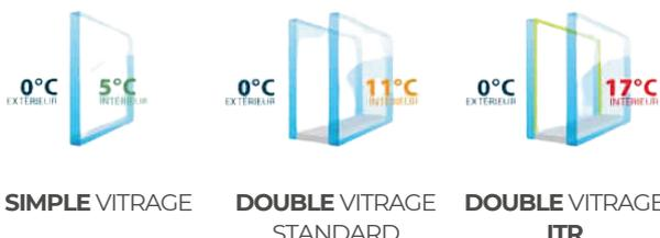
Le double vitrage conserve la chaleur à l'intérieur grâce à une couche dite ITR. En hiver, il permet d'isoler du froid tout en laissant passer la lumière et la chaleur du soleil.
