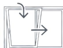
Le couissant PATIO est un **translation à frappe** avec système de fermeture par compression des joints. Cette solution garantie une **étanchéité maximale** et d'excellentes performances acoustiques et thermiques ( $U_w$  jusqu'à 0,8). Il est conçu avec **12 points de verrouillage en périphérie** pour retarder l'effraction.
